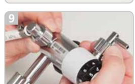
**9 Druckschlauch und Anschlussstülle anschrauben**
