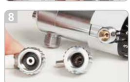
**8 Dichtringe in den Verschraubungen prüfen**
