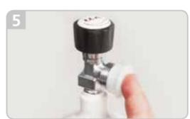
**5 Verschließen des Flaschenventils**
