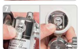
**7 Wartungsaufkleber des OXYWAY-Druckminderers auf Fälligkeit prüfen**
