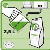
**4a** 2,5 L Incidin™ Desinfektionslösung einfüllen.
