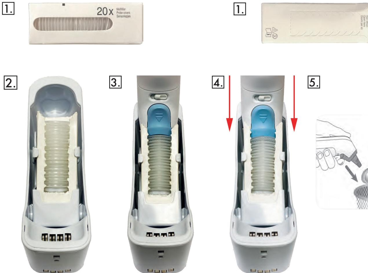
Hinweis: Produktspezifisch ist zu beachten, dass beim Aufsetzen der SafeTemp Schutzkappen durch Drücken der Messspitze in die Entnahmepackung, der Schutzkappen-Stapel etwas nachgeben kann (vgl. Bild 3/4). Im Vergleich zum Produkt vom Originalhersteller ist daher ein etwas höherer Druck erforderlich um die Schutzkappen festsitzend aufzubringen.
